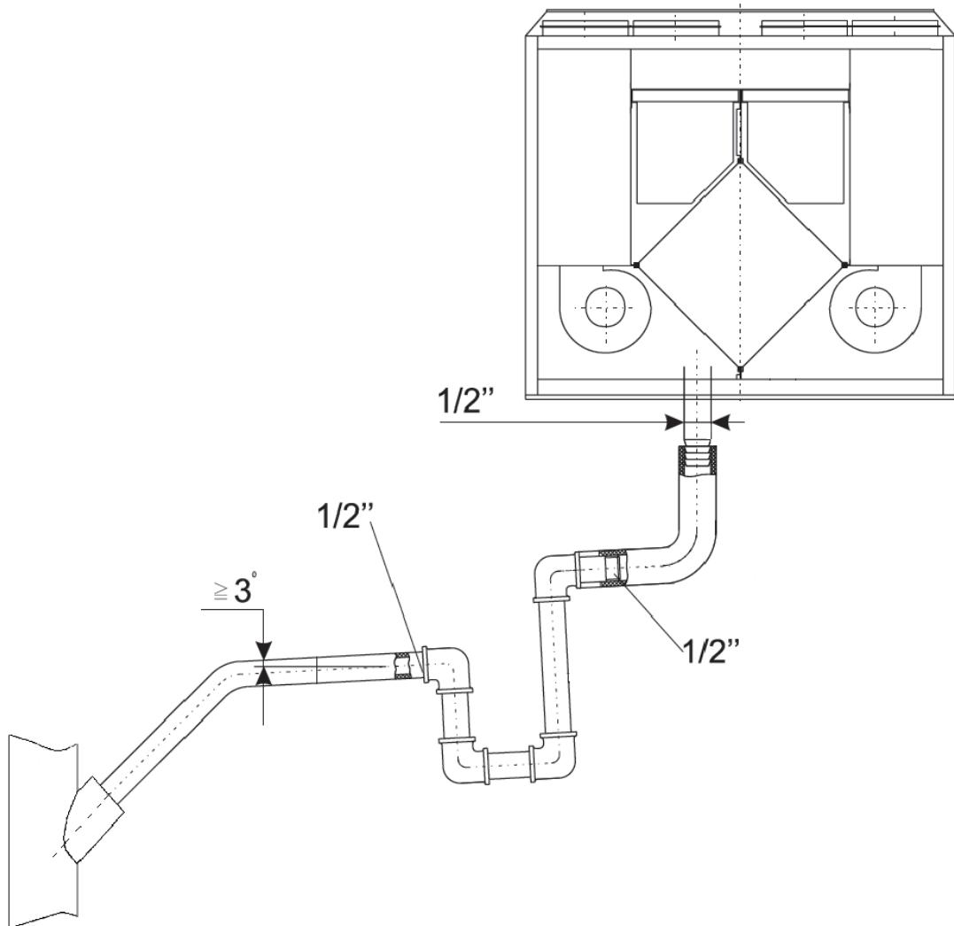
Если температура в помещении, где установлен агрегат, ниже 0°C, то система отвода дренажа должна быть теплоизолирована надлежащим образом.
